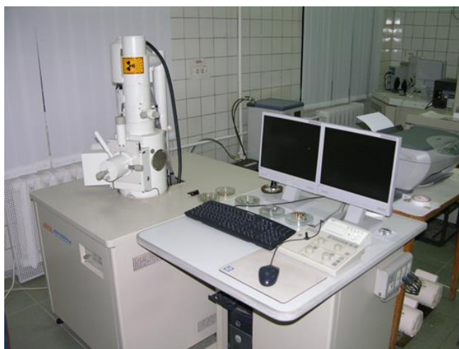
Рис. 18. Сучасний сканувальний електронний мікроскоп – JSM 6060 LA, японської фірми JEOL. Прискорююча напруга – 30 кВ (Фото Д. О. Климчука).
