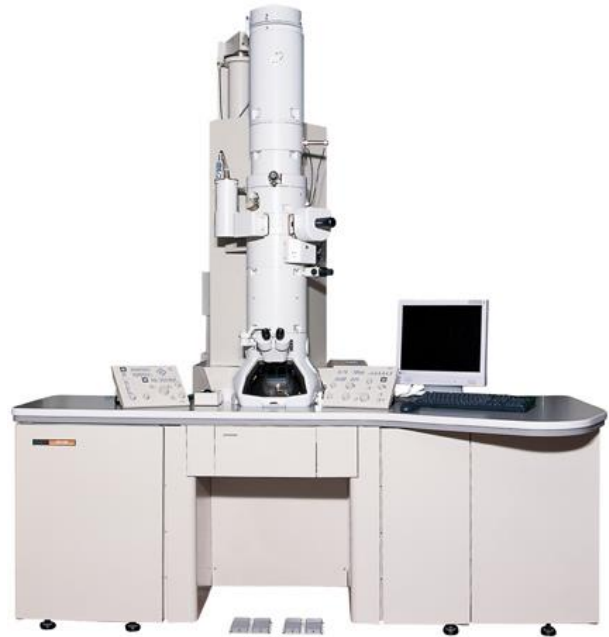
Рис. 2. Сучасний трансмісійний електронний мікроскоп – JEM 2100. Прискорююча напруга – 200 кВ (Фото: www.jeol.co.jp ).
